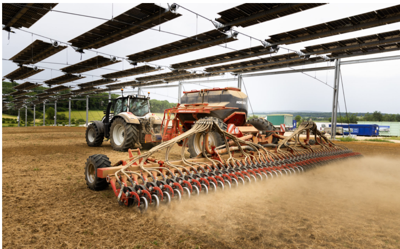
L'ombrière de cinq mètres de hauteur permet le passage des gros engins agricoles. Image : TSE
